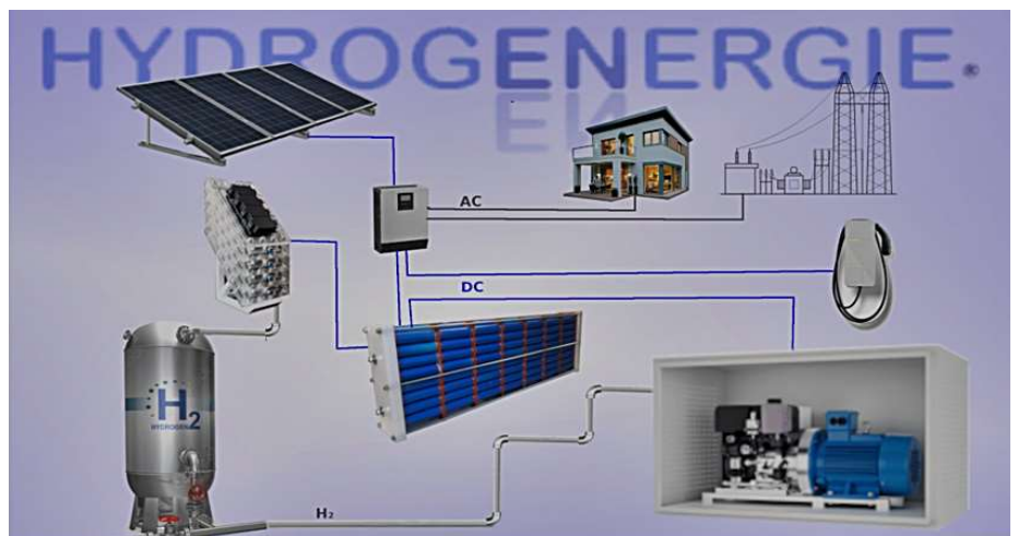
Wenn die PV-Anlage Überschuss liefert, kann über die Elektrolyseanlage von alpha-apex-industries Wasserstoff hergestellt und zwischengespeichert werden. Bei Bedarf lässt sich der Wasserstoff über einen EVS-Motor verstromen und wieder in Batterien puffern und dann im Haus direkt nutzen oder ins Netz einspeisen, wenn der Einspeisetarif attraktiv ist.
