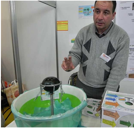
Mohamed Essaady zeigt hier mit einem Schwingungselement im Wasser, wie Vibrationen in elektrische Energie umgesetzt werden können.
