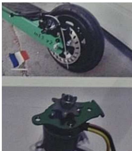
Oben: Hinterradantrieb, unten: der verwendete Elektromotor.
