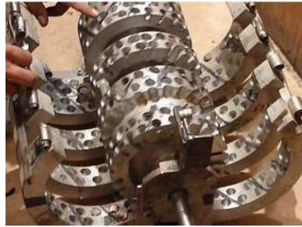
Magnetmotor von Wasif Kahloon mit Permanentmagnet-Läufer und aufgeklappten Permanentmagnet-Statorhälften.
