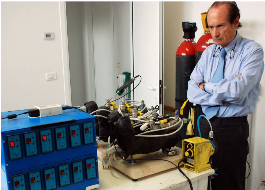
Andrea Rossi vor 4 E-Cat-Aggregaten, der zugehörigen Steuerelektronik (links) und der Regeleinheit für die Wasser-Durchfluss-Pumpe. (Bild Daniele Passerini Blog)
