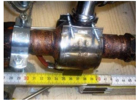
Blick auf den eigentlichen Reaktorteil mit einem Volumen von etwa 50 Kubikzentimeter. Die Länge beträgt rund 5 cm (siehe Markierung im Massstab von 35 cm bis 40 cm) (Foto: Giuseppe Levi)
