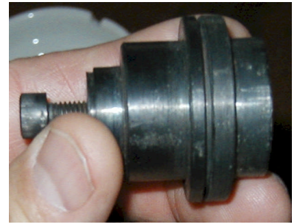
Metallzylinder, der als Giessform zur Herstellung des Abschirmmaterials (vermutlich Bismut) diente.
