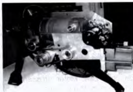
MDI-Zweizylinder-Motor-Einheit mit 980 ccm Hubraum und 35 kg Gewicht (1/3 des üblichen Motorgewichts)
