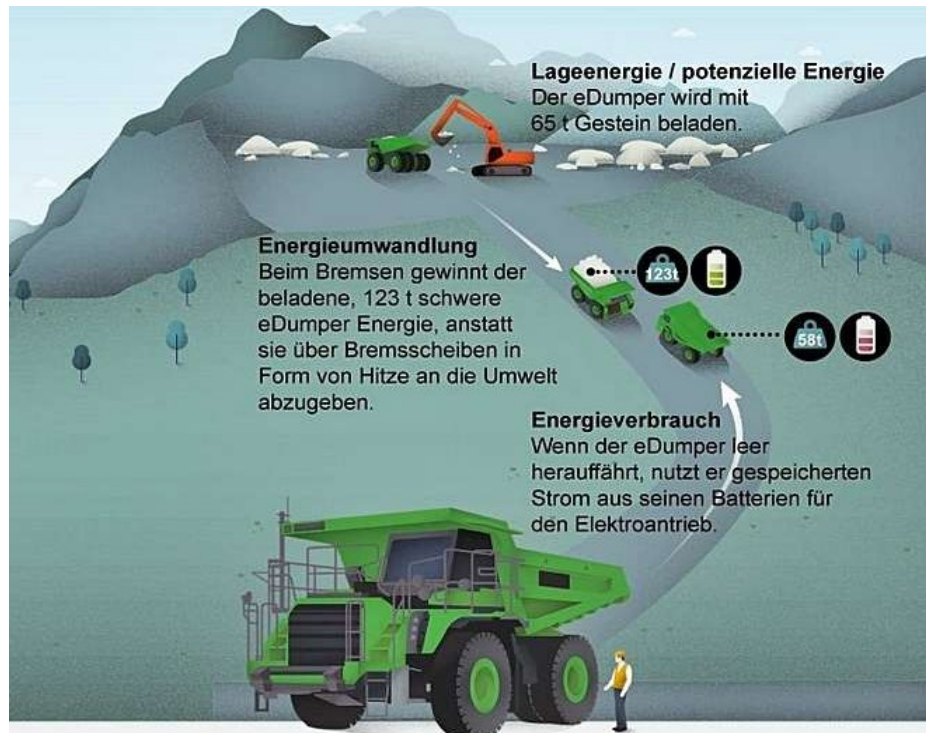
Der E-Dumper rekuperiert die Bremsenergie und erzeugt noch Strom.
