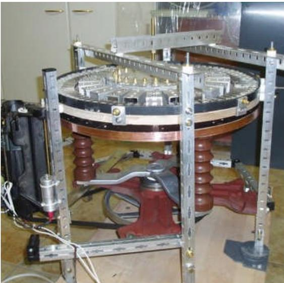
PM3-Maschine mit externem Antrieb durch einen Waschmaschinenmotor, der über eine Riemenverbindung angekoppelt wird. Das PM3-Aggregat ist auf drei hohe Porzellan-Abstandshalter aufmontiert (Durchmesser Rotor: 40 cm, Stator: 54 cm).
