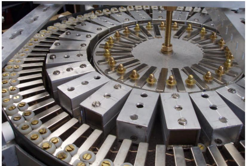
Aufsicht auf die Rotor- und Statormagnete der mit senkrechter Achse gelagerten PM3-Maschine. Es zeigte sich, dass offenbar eine unerwünschte gegenseitige Beeinflussung der Magnetfelder des externen Antriebsmotors und des PM3-Rotors auftritt. Durch eine andere Anordnung soll dieser Störereffekt künftig beseitigt werden (Durchmesser Rotor: 78 cm, Stator: 93 cm).
