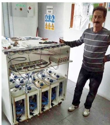
Ljubisa Markovic demonstrierte uns am 28. Mai 2023 in seinem Labor in Neu-Belgrad diese stationäre Anlage mit 12 HHO-Zellen, die bei Anlegen einer Spannung von 12 V und 0,35 A HHO freisetzen.
