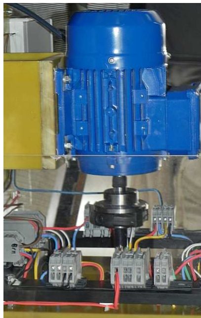
Blick auf den Antriebsmotor der PENS-Anlage von Hans-Jürgen Brachmann.
