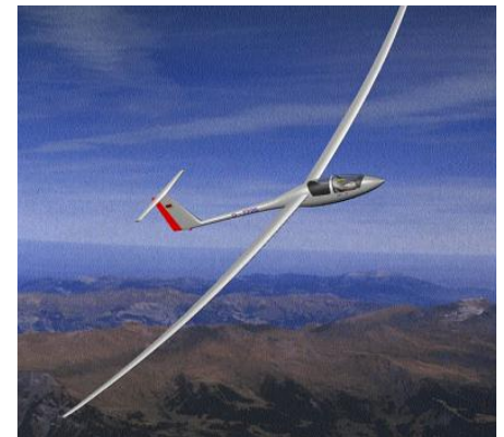
Beim dynamischen Segelflug wird die optimale Flugbahn aufgrund der höhenveränderlichen Horizontal-Windfelder (Windscherung) berechnet.
