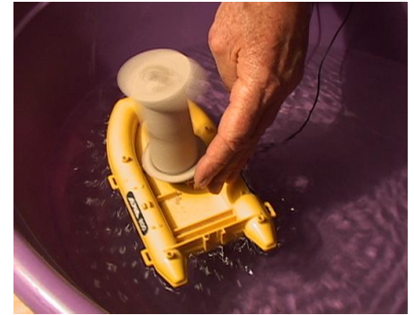
Nachweis des Magnus-Effektes bei „Windstille“ am Badewannenmodell eines Flettner-Rotor-Antriebs
