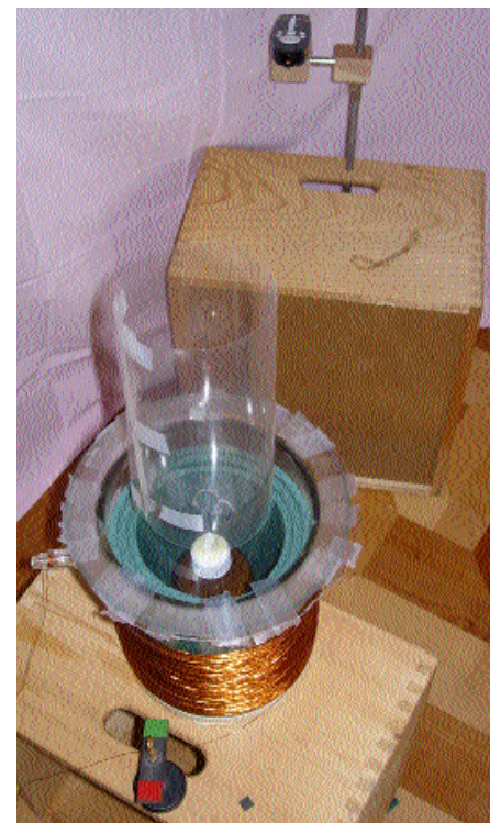
Abb. 5: Die Versuchsanordnung zum Nachweis der rotatorischen Wirkung des Magnetfeldes auf einen diamagnetischen Körper. Eine mit Sand gefüllte Glasflasche, von welcher von oben nur der weisse Deckel und der obere Rand des braunen Glaskörpers sichtbar sind, hängt dreifach isoliert in einem mittels Kupferdrahtwicklungen zu einem kräftigen Elektromagneten umfunktionierten gläsernen Labortopf von etwa 20 cm Durchmesser und 25 cm Höhe. Der sehr dünne Nylonfaden der Aufhängung ist auf dem Bild kaum erkennbar. Der Topf ist durch einen mit einem Loch für die Aufhängung versehenen Acrylglas-Deckel abgedeckt, und auch der darüber an den Aufhänge-Fäden geklebte viereckige Laser-Messspiegel ist mit einem nach oben offenen, aus einer transparenten Folie hergestellten kurzen Rohr gegen Luftströmungen partiell abgeschirmt. Im Hintergrund die Laserquelle, durch deren zurück gespiegelten Strahl die Schwingungen des etwa 400 gr. schweren Drehpendels genau auf 4-mm-kariertes Papier übertragen werden können. Je nach Stromrichtung zeigen sich signifikante und gut reproduzierbare Unterschiede in der Auslenkung des Pendels.
