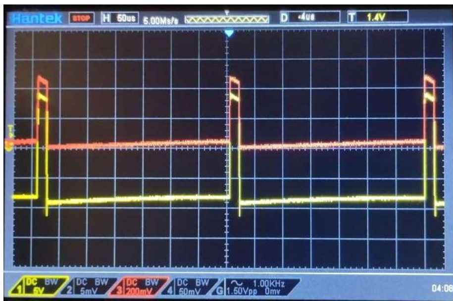
Bild 20: Diagramme für Eingangsspannung (gelb) und Ausgangsspannung (rot) des Kabel-TraKos in Bild 11 (Weiteres siehe Versuchsbeschreibung)
