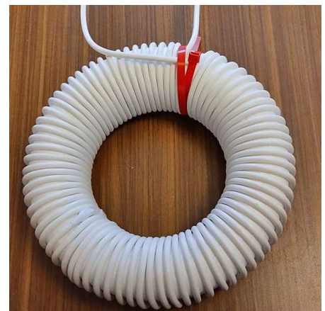
Bild 14 Kabel-TraKo mit Styropor-Toroiden (25 cm Durchmesser), Bewicklung 3 X 0,75 qmm:
