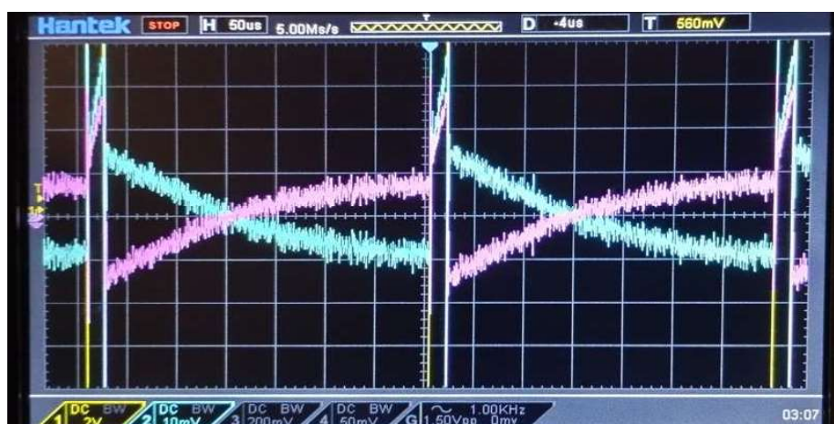
Bild 19: Diagramme für Eingangsspannung (gelb), Eingangsstrom (blau) und Eingangsleistung (violett) des Kabel-TraKos in Bild 11
