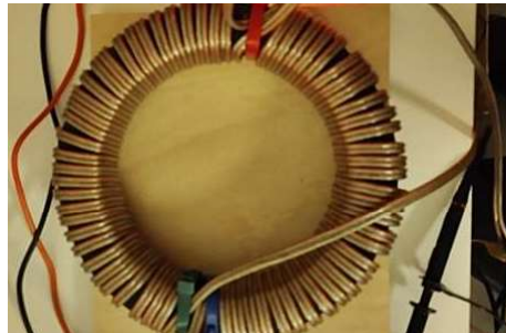
Bild 6: TraKo mit nanokristallinem MET-GLAS-Toroiden (20 cm Durchm.), beide Wicklungen in Tesla-Beschaltung
