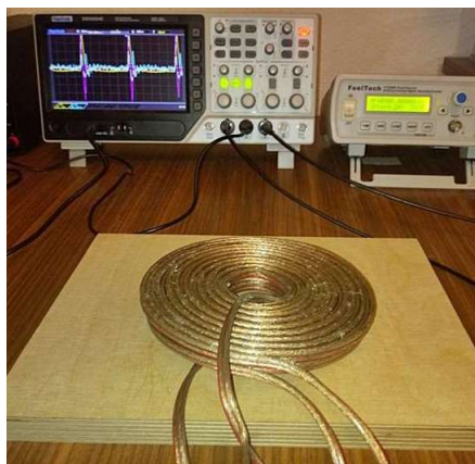
Bild 15: Kabel-TraKo, bestehend aus zwei bifilaren Tesla-Pancake coils
