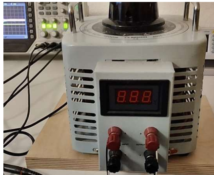
Bild 9: Spartransformator als TraKo-Element
