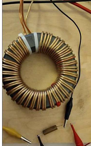
Bild 3: Ferrit-Toroid-TraKo mit 32 Doppelwindungen, 12 cm Durchmesser
