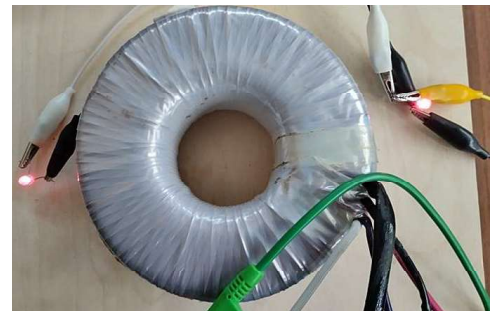
Bild 7: Ringkern-TraKo aus Trafo-Blech, Arbeitsfrequenz 2 KHz
