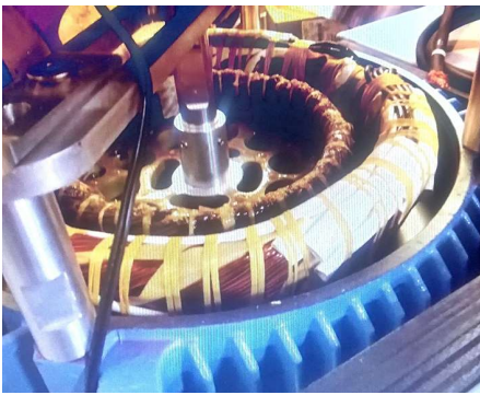
Foto des umgebauten 40-PS-Motors in einem Betrieb in Nashville, der auf die HES-Technologie umgerüstet wurde.
