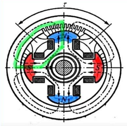
Klassischer elektrischer Synchron-generator Mit statischen Wicklungen im Ständer und einem sich drehenden Rotor mit ausgeprägten Polen.
