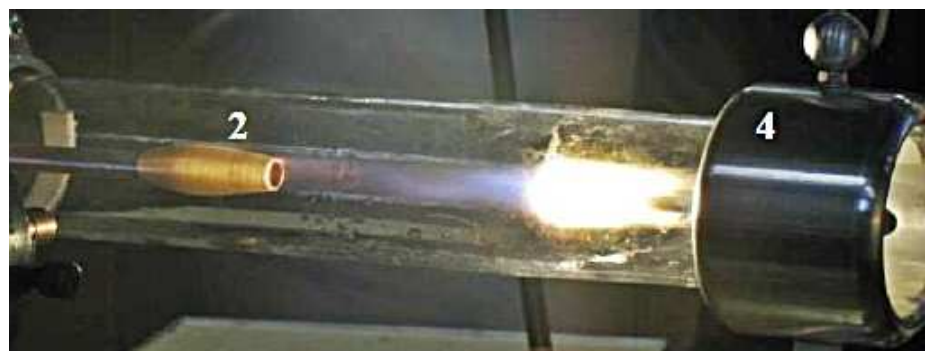
Reaktor-Quarzrohr mit der Düsen 2 und der Kathode 4.
