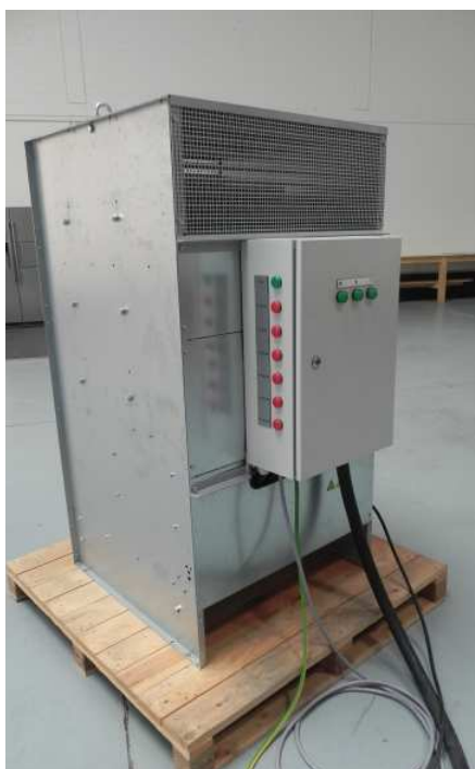
Heizsystem mit mehreren zuschaltbaren grossen Heizwiderständen von 15 kW, 20 kW und 25 kW sowie einem Ventilator.
