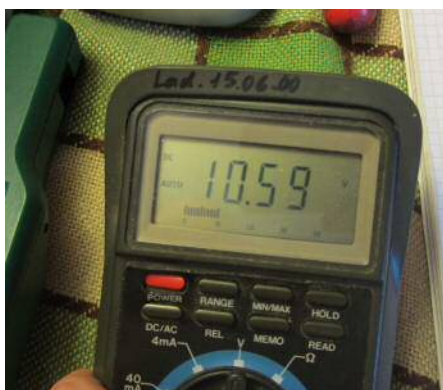
Ausgangsspannung bei voller Belastung mit 300 W.
