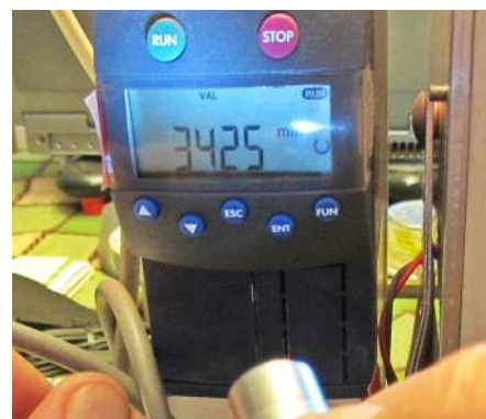
Anzeige der Umdrehungszahl des Motors bzw. Generators pro Minute.
