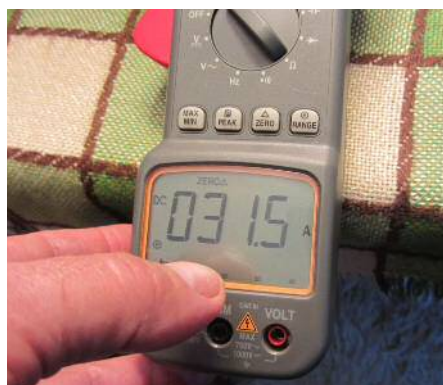
Ausgangsstrom bei voller Belastung mit 300 W.
