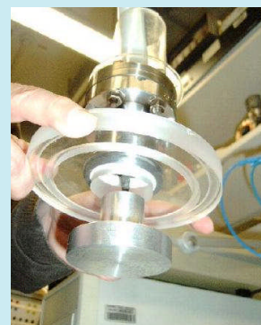
Die Feldquelle aus Aluminium war am Deckel flansch befestigt und konnte bis auf 30 kV von einer Hochspannungsquelle aufgeladen werden.
