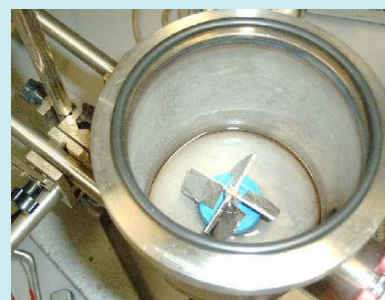
Geöffnete Vakuumkammer mit Blick auf den 51 mm grossen elektrostatischen Rotor.
