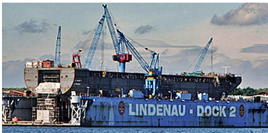
Rumpf von E-Ship 1. Es handelt sich um ein Rotorschiff, das für die Firma Enercon gebaut wurde. Dieses Schiff wurde ergänzend mit vier Flettner-Rotoren angetrieben.
