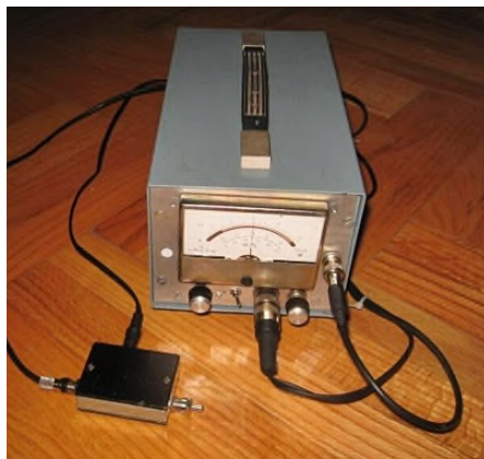
Bild 1a: Vorverstärkergehäuse im Vordergrund dahinter der Hauptverstärker mit Filter und Netzteil.
