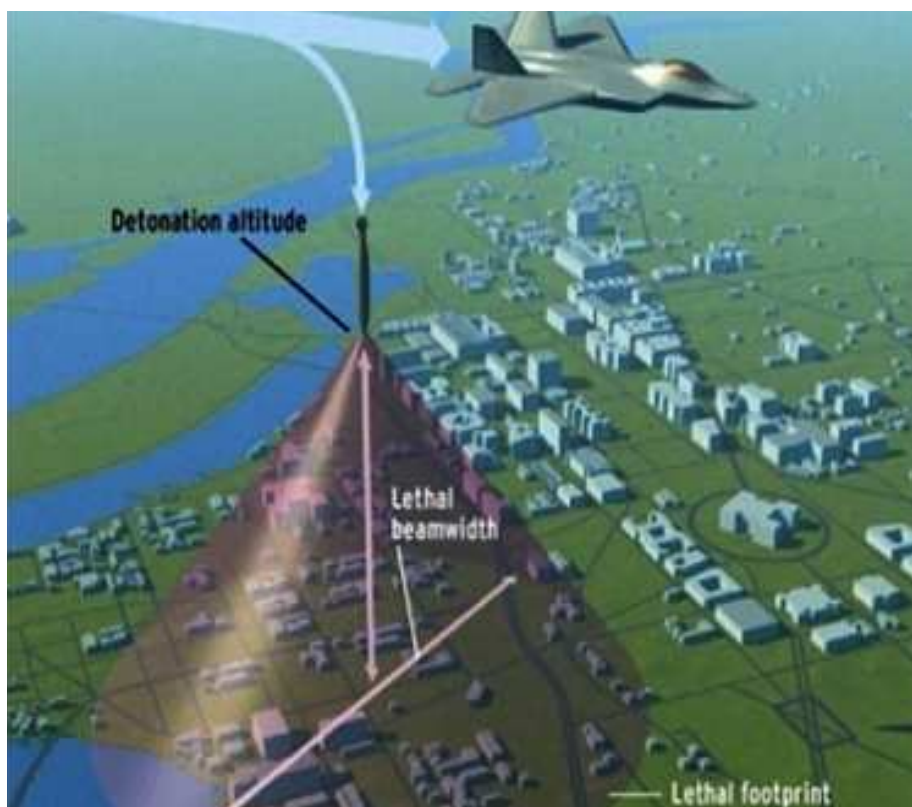
Illustration zur Wirkung eines MP-Impulses, der von einer Rakete kegelförmig zum Boden ausgestrahlt wird. So werden in einem Gebiet von Dutzenden bis Hunderten von Kilometern alle elektrischen Systeme lahmgelegt.
