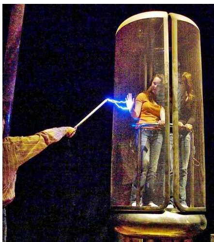
Faradayscher Käfig, besetzt mit Probanden im feldfreien Innenraum.
