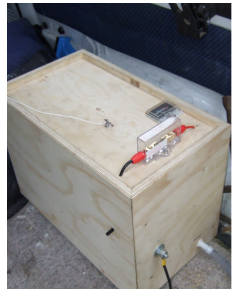
Hier ist der Kunststoffschlauch sichtbar, aus dem das H_2-O_2 -Gas in den rechts sichtbaren Luffilter strömt. Das Hydroxid-Gas wird im Gasgenerator erzeugt, der in der unten sichtbaren Holzbox im Kofferraum eingebaut ist.
