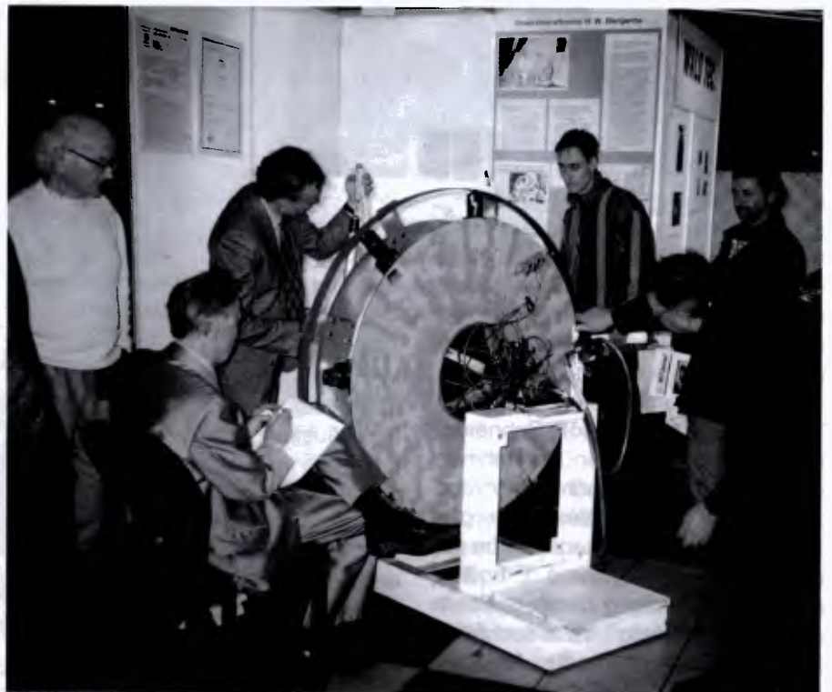
Dr. Hans Weber und Adolf Schneider bei der Ermittlung der mechanischen Leistung des Gewichtskraftmotors mit dem Pronyschen Zaum (Bremskraftdynamometer).
