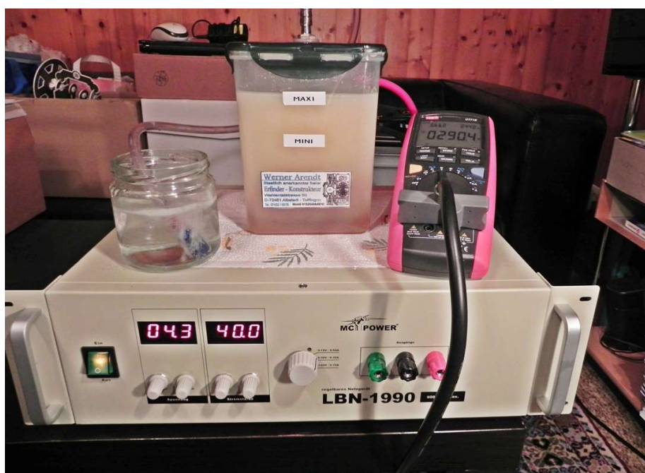
Hier abgebildet ist der Hydrolyseur auf dem Netzgerät mit 40 A Stromfluss bei 4,3 V, den die Redaktoren dem Erfinder W. A. zu eigenen Messungen abkauften.
