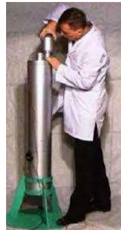
Die von einer 250-kW-Anlage abgegebene elektrische Leistung wird auf eine Ohmsche Last (Heizwiderstände) ausgetragen und mit entsprechenden Messinstrumenten überprüft. Es geht hierbei um die Messung der direkt aus der Anlage ausgekoppelten Hochspannung und des in der Last fließenden Stroms. Die gesamthaft produzierte Energie errechnet sich dann aus der effektiven Leistung und der Gesamtzeitdauer des Tests.
