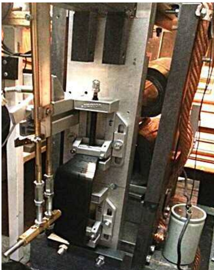
Bild 4: Prüfstand mit Reifensegment
