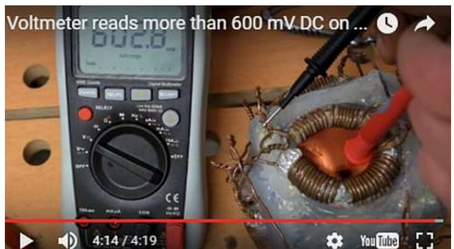
Messung einer Gleichspannung an einer Kegelspule eines Q6.
