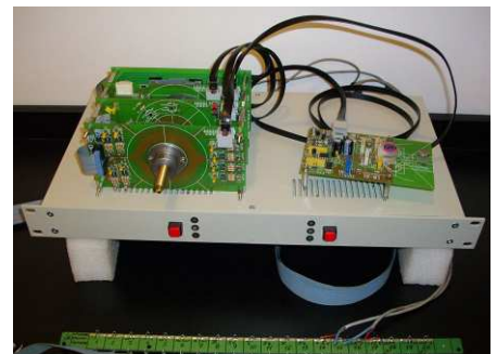
Die von Panjovics Labor entwickelte elektronische Steuerung zum Doppelpendel.
