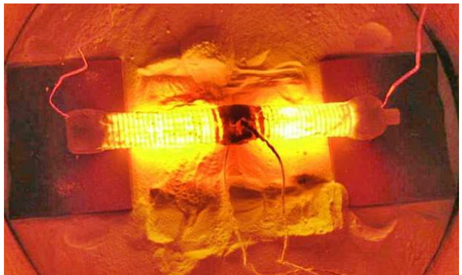
Blick auf die Reaktorröhre in aufgeheiztem Zustand. Die äussere thermische Isolierung ist hier entfernt, ebenso fehlt der Metallbehälter des Kalorimeters, in das die Röhre für den kalorimetrischen Test eingeführt wurde.
