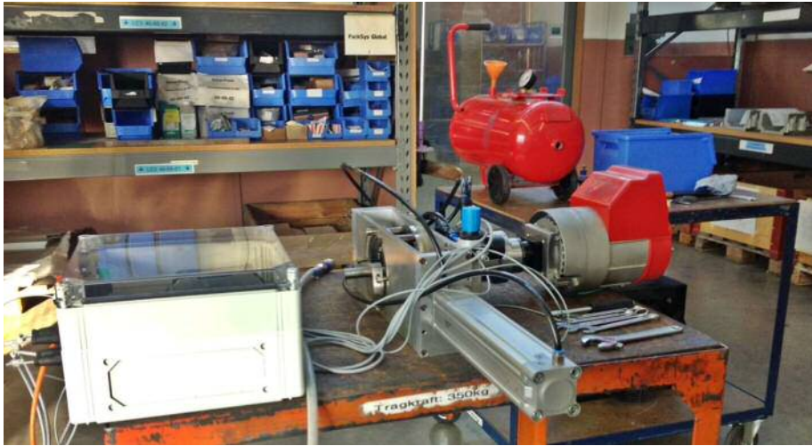
Prototyp des Druckluftmotors von Arno Fimian auf einem Arbeitstisch mit dahinter aufgebautem Pressluftgenerator (rot) und einer links sichtbaren Messanordnung.
