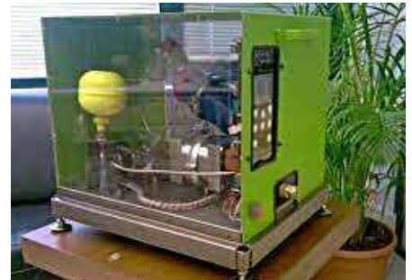
Defkalion-Modell eines 5-kW-Geräts mit Reaktor-Innenmassen von 12 x 12 x 12 cm.
