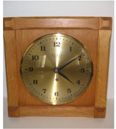
Vorderseite der mit einer Kristallzelle autonom betriebenen Wanduhr.
