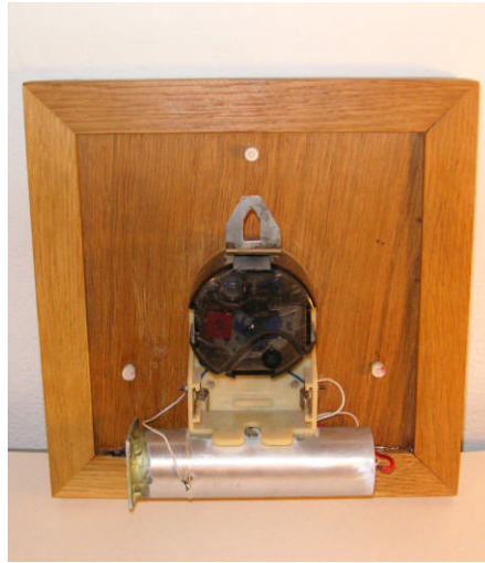
Wanduhr mit Kristallbatterie, die unter dem Uhrwerk eingebaut ist.
