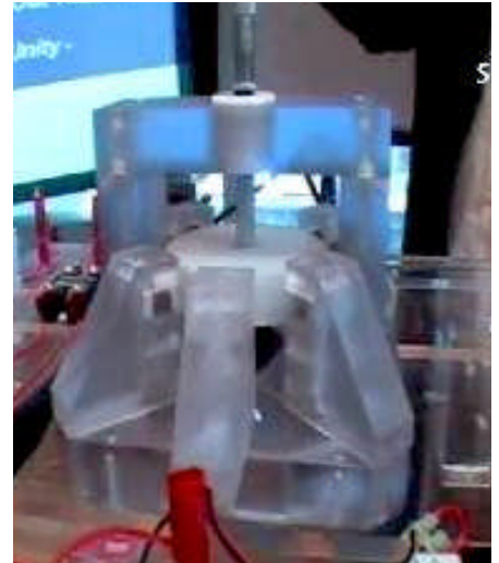
Nahansicht des Orbo-Plexiglasmodells mit einem Rotor, der mit Permanentmagneten bestückt ist, und vier Statorspulen.
