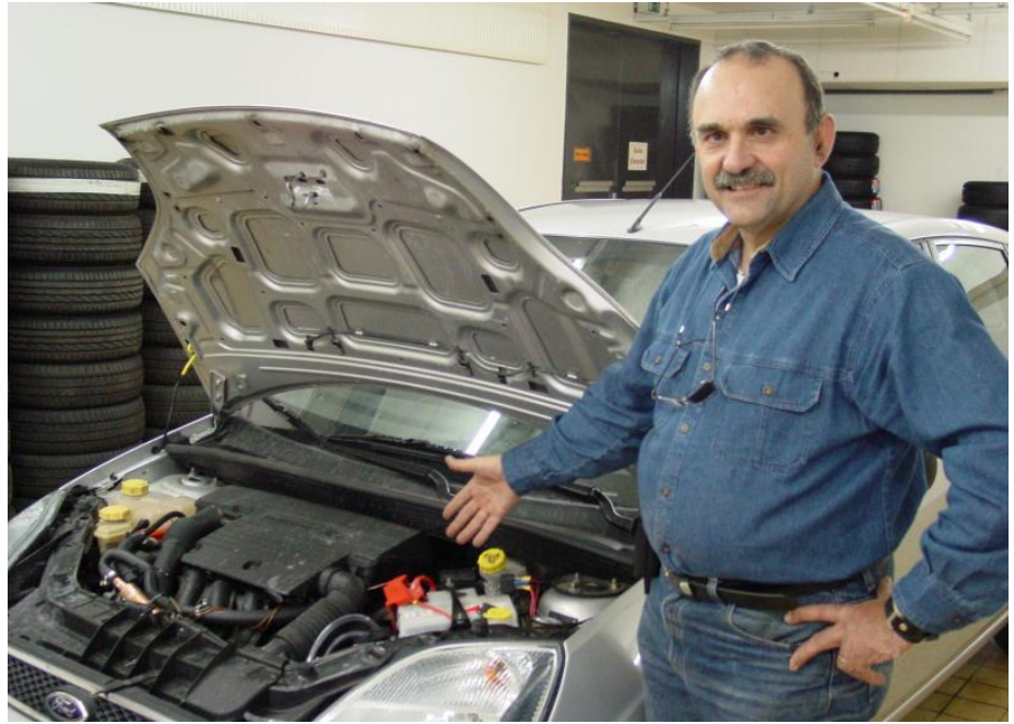
Francis Giroux vor einem umgerüsteten Ford Fiesta bei einem Besuch in Wien im Januar 2006. Links ist der Einbau des Treibstoff-Vorwärmers zu sehen, rechts in Richtung der ausgestreckten Hand sind die transparenten Anschluss-Schläuche des Wasserbehälters zu erkennen, unterhalb dessen sich der Elektrolyseur befindet.
