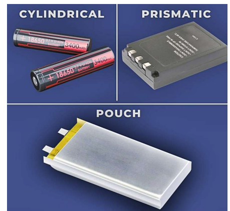
Verschiedene Lithium-Zellen: zylindrisch, prismatisch, Pouch.
